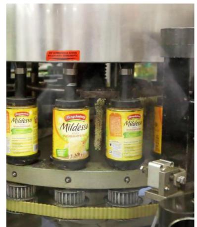
Produkt identifizierbar: Eine Etikettiermaschine setzt den Schlusspunkt.
