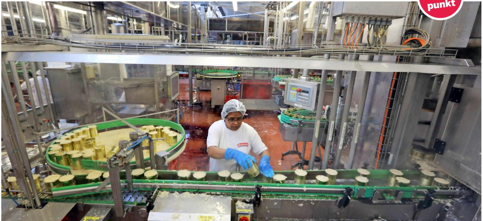
Die gefüllten Sauerkrautdosen rattern über Fließbänder in die nächste Station. Dort werden die Deckel eingesetzt. Und das alles unter den wachsamen Augen der Hengstenberg-Mitarbeiter.
