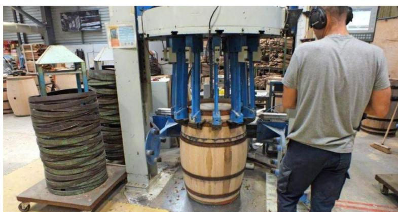
Mechanische Kraft: Diese Maschine hilft dabei, die grauen Arbeitsringe durch die endgültigen Stahlringe zu ersetzen. Sie pressen die Dauben mit hohem Druck aneinander.
